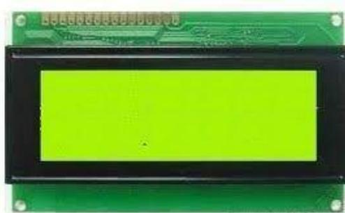
Figura 14 - Display LCD 20x2.
