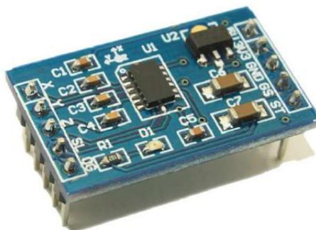
Figura 1 - Acelerômetro MMA7361L
